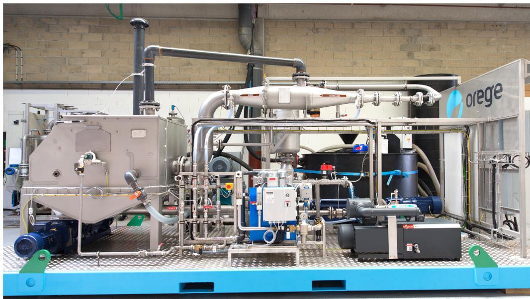
Le produit SLG-F est une combinaison de la solution de conditionnement SLG et de l'outil propriétaire Orège, le Flosep (F), pour la séparation et l'épaississement des boues
